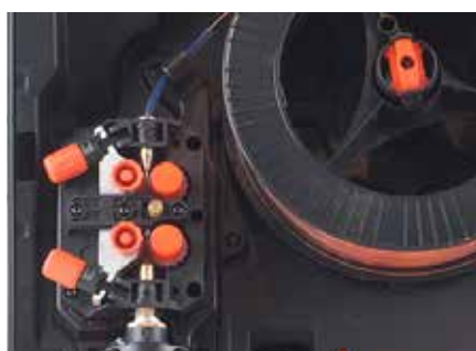
Les modèles Kempact 253/323 comprennent le système de dévidage à 4 galets DuraTorque.
