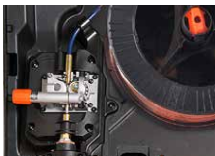
Les modèles Kempact 251 comprennent le système de dévidage à 2 galets GT02C.
